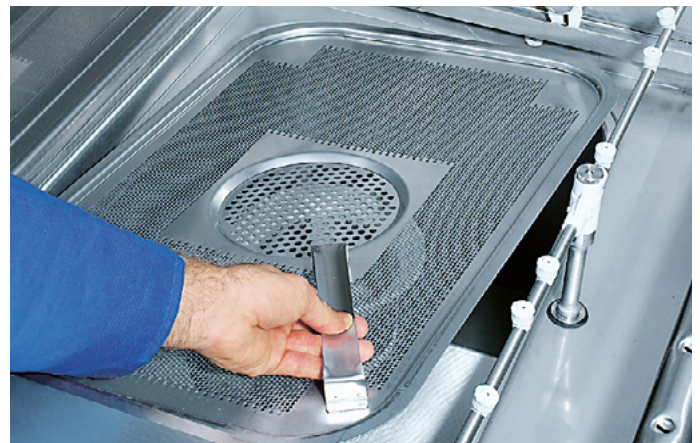
Tankabdecksieb Gezielte Schmutzabführung in den AktivPlus-Feinfilter. Kehr- schaufeleffekt bewirkt einfache Beseitigung von Grobschmutz.
